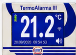
PANTALLA PRINCIPAL Supervisa la temperatura en tiempo real.
